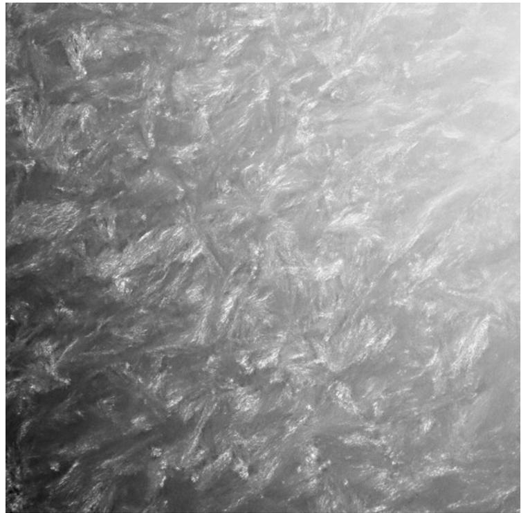
Fig.4- Crystallites dans du polyéther-éther-cétone (microscopie électronique en transmission, © cliché A. Boudet)
