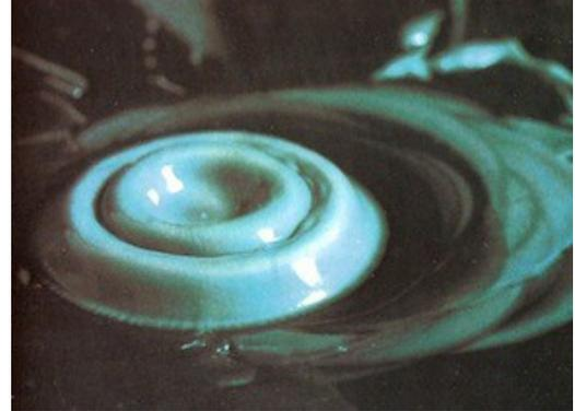
*Forme de disque dans un liquide très visqueux. En surface du disque, il se déplace radialement du centre vers la périphérie et il revient vers le centre par le dessous
