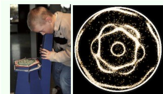
A gauche, un type de tonoscope
