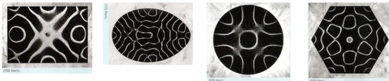
Figures acoustiques pour des plaques de formes différentes. De gauche à droite, fréquences voisines de 2150, 2515, 1079, 1600 Hz. Photos © A. Lauterwasser, Images sonores d'eau
