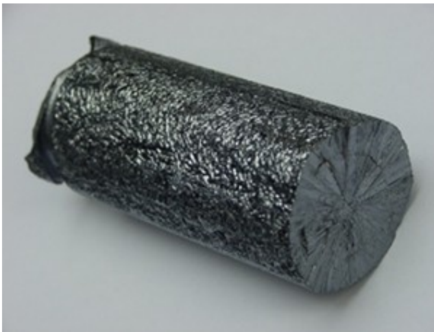
Fig.32- Barreau de silicium polycristallin, destiné à la production de silicium monocristallin (longueur 10,3 cm, diamètre 4 cm). Merci à Wikipedia
