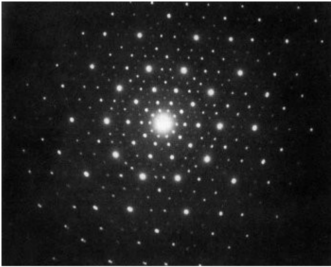
Fig.22- Diagramme de diffraction d'un quasi-cristal de symétrie 5. Merci aux chimistes de l'Université Louis Pasteur de Strasbourg
