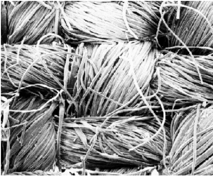
Fig.6- Dans une toile, les fils de coton entrecroisés sont faits de faisceaux de fibres (microscopie électronique, © cliché A. Boudet)
