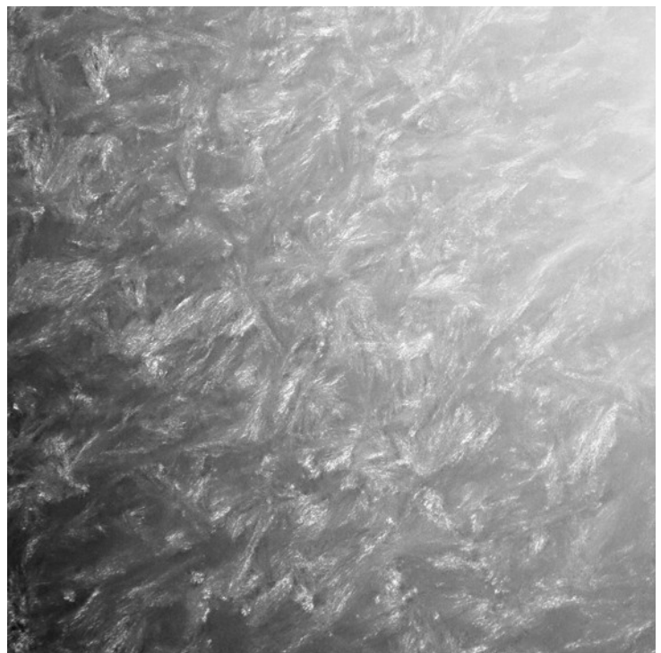
Fig.4- Cristallites dans du polyéther-éther-cétone (microscopie électronique en transmission, © cliché A. Boudet)
