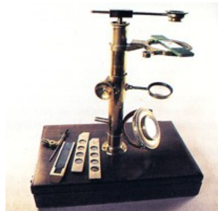
Fig.2- Microscope fabriqué vers 1820 par Robert Bancks. A l'étage intermédiaire, on distingue la lame de verre sur laquelle on déposait l'objet à examiner, comme on le fait encore.
